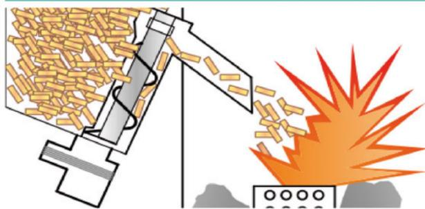
La termostufa Niagara è l'unica della produzione Carinci che si avvale del sistema tradizionale di alimentazione del pellet per caduta nel bruciatore dall'alto.
